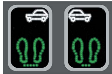
Рис. 26. Такты зеленой фазы пешеходного односекционного светофора в последние секунды горения
