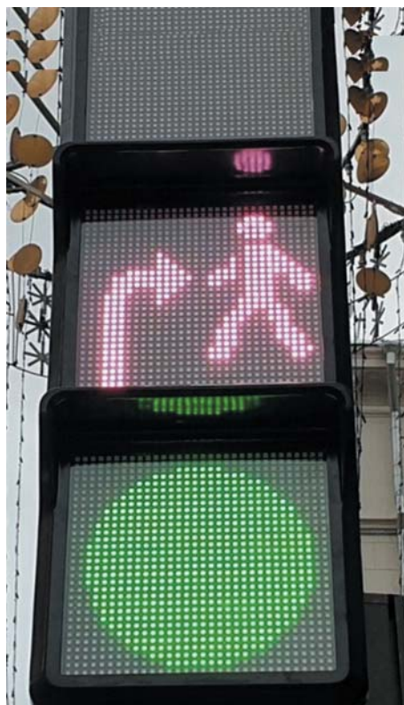
Рис. 5. Вариант автодорожного светофора с «бело-лунным» сигналом предупреждения
