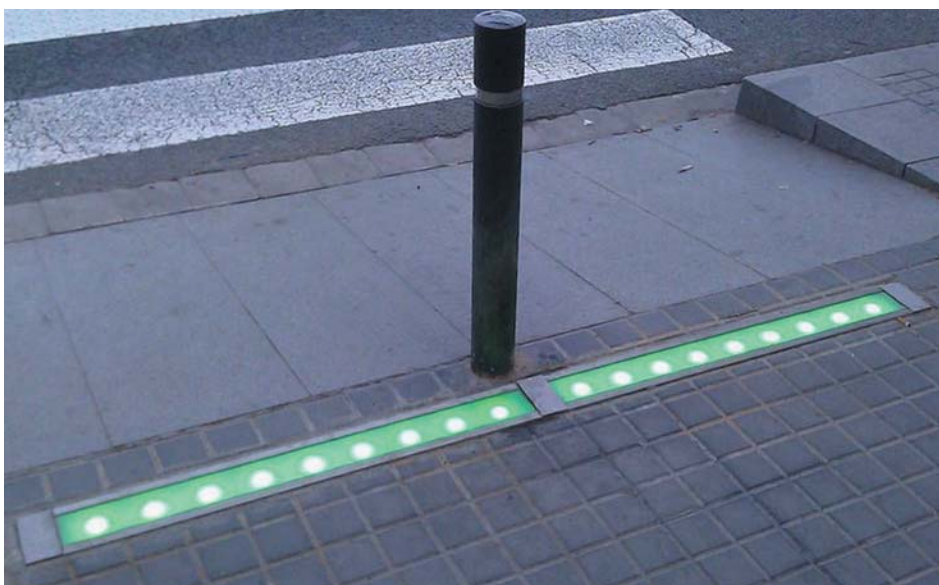
Рис. 10. Вариант «повторителя» пешеходного светофора для гаджетоманов
