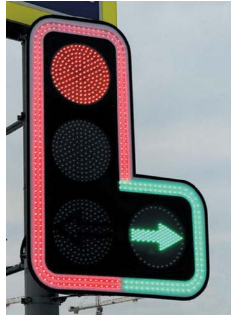
Рис. 8. Вариант автодорожного светофора со светящимся контуром
