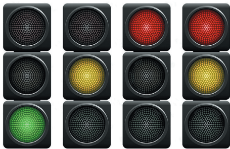
Рис. 1. Такты современного светофора. Два основных такта (зеленый и красный) и два промежуточных
