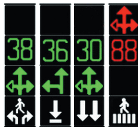
Рис. 7. Четыре такта четырехсекционного светофора новосибирских инноваторов
